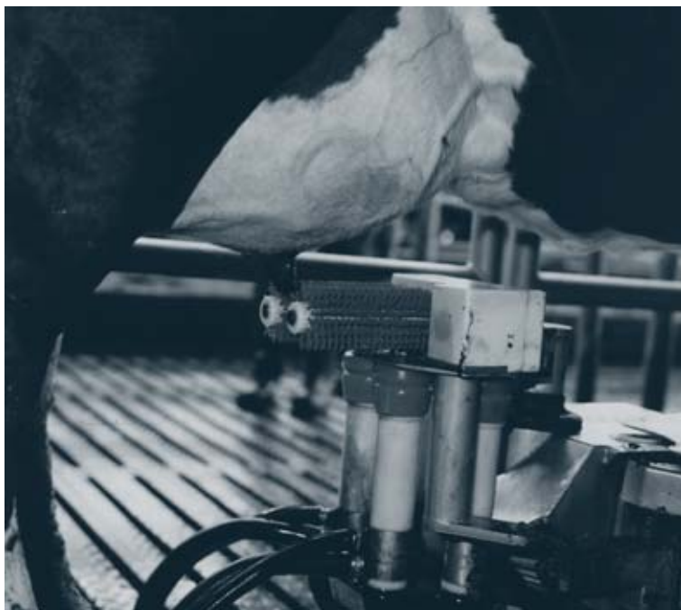
Speenreiniging bij automatisch melken met borstels.
